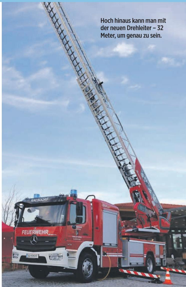
Hoch hinaus kann man mit der neuen Drehleiter – 32 Meter, um genau zu sein.
